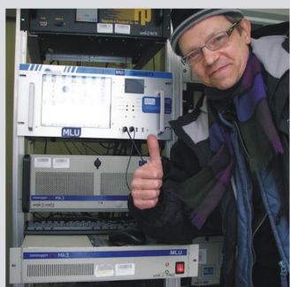
Analizator BTX z detektorem FID Airmo BTX 1000 model GC 866 zakupiony w ramach projektu współfinansowanego z NMF zainstalowany na stacji pomiarowej w Warszawie przy ul. Wokalnej 1
