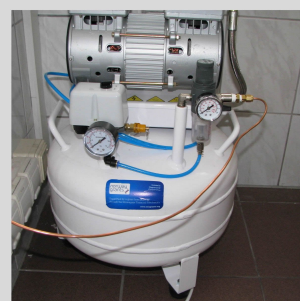
Sprężarka do stacji do generowania gazów do chromatografów gazowych z detektorem FID
