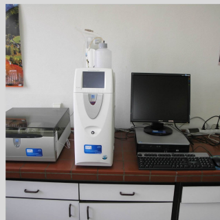
Chromatograf jonowy DIONEX ICS-2100 zainstalowany w laboratorium w Radomiu
