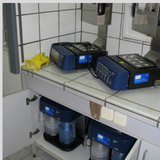
Piecyce do mineralizacji próbek do oznaczania azotu Kjeldahla Digester 8 Auto Rack ze skruberami zainstalowane w laboratorium w Płocku
