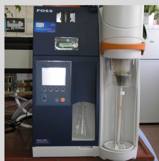
Moduł destylacyjny Kjeltec 8200 do oznaczania azotu Kjeldahla zainstalowany w laboratorium w Radomiu
