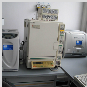
Generator wodoru i powietrza zerowego (w głębi)
