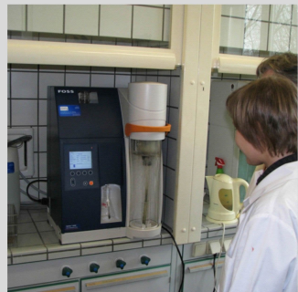
Moduł destylacyjny Kjeltec 8200 do oznaczania azotu Kjeldahla zainstalowany w laboratorium w Warszawie
