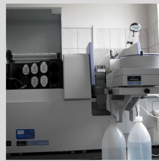
Spektrometr Absorpcji Atomowej AAnalyst 600 z kuetwą grafitową
