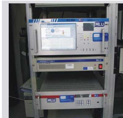
Analizator BTX z detektorem FID Airmo BTX 1000 model 866 z wytwornicą wodoru Hydroxichrom i wbudowanym generatorem powietrza zerowego zakupiony w ramach projektu współfinansowanego z NMF
