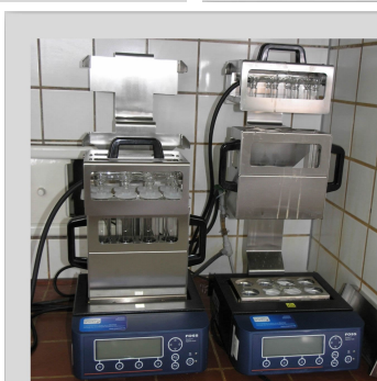
Piecyce do mineralizacji próbek do oznaczania azotu Kjeldahla Digester 8 Auto Rack zainstalowany w laboratorium w Radomiu
