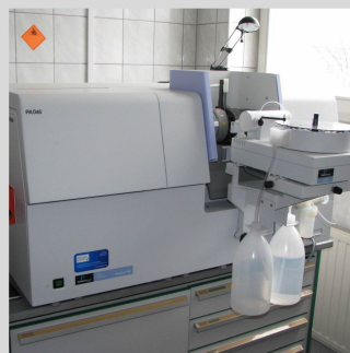
Spektrometr Absorpcji Atomowej AAnalyst 600 z kuetwą grafitową
