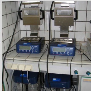
Piecyce do mineralizacji próbek do oznaczania azotu Kjeldahla Digester 8 Auto Rack ze skruberami zainstalowane w laboratorium w Warszawie
